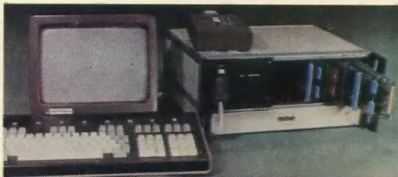
Прототипная система с программатором ППЗУ
